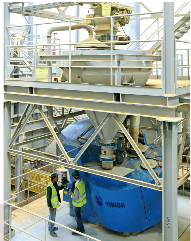
Misturador intensivo otimiza o beneficiamento de minério
